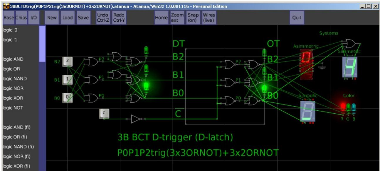
Снимок модели троичного трёхбитного (3В ВСТ) одноступенчатого D-триггера (D-latch) P0P1P2trig(3x3ORNOT)+3x2ORNOT в логическом симуляторе Atanua/Win32 1.0.081116 - Personal Edition.
