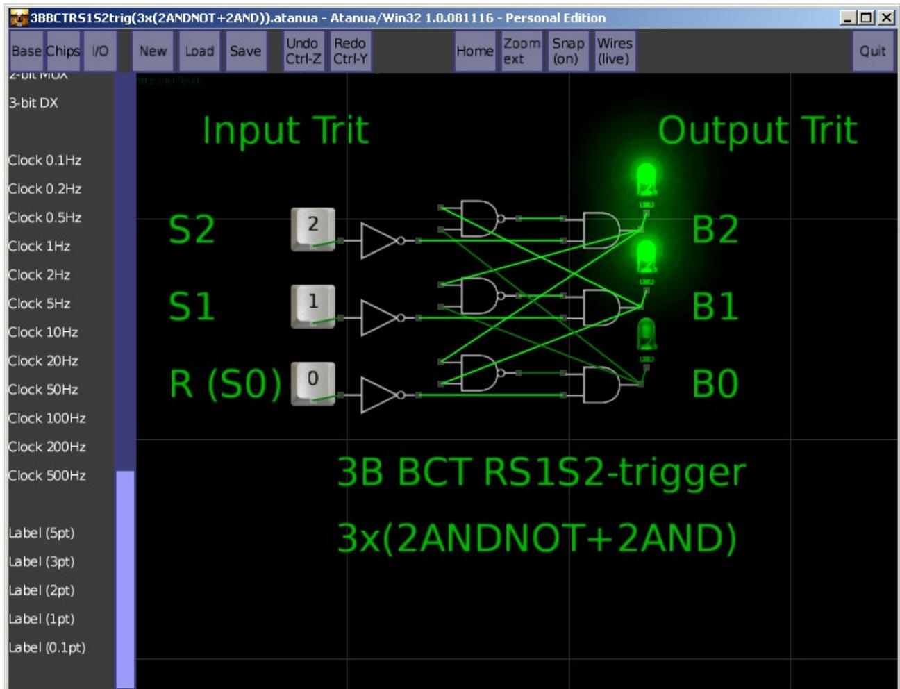
Снимок модели троичного трёхбитного (3В ВСТ) RS1S2-триггера 3x(2ANDNOT+2AND) в логическом симуляторе Atanua/Win32 1.0.081116 - Personal Edition.
