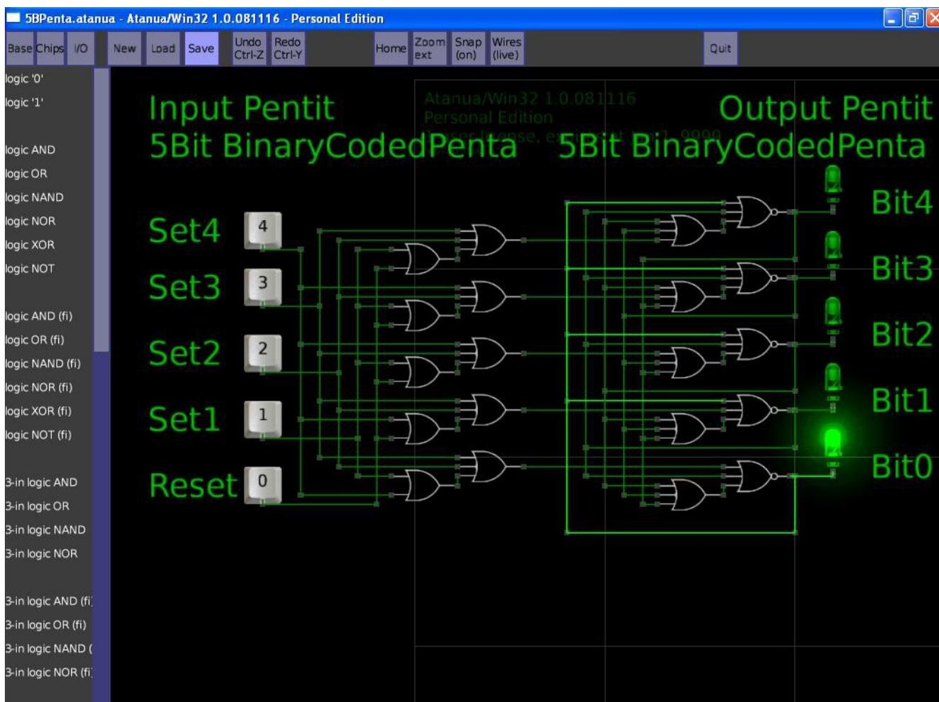
Рис. 1. Снимок модели пятиричного пятибитного RS1S2S3S4-триггера в логическом симуляторе Atanua/Win32 1.0.081116 - Personal Edition.
