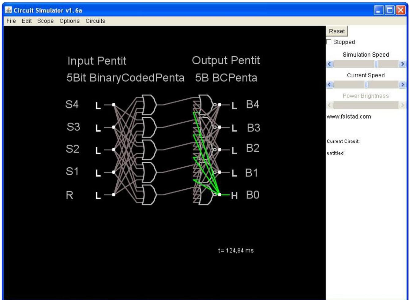
Рис. 2. Снимок модели пятиричного пятибитного RS1S2S3S4-триггера в логическом симуляторе Circuit Simulator v1.6a.
