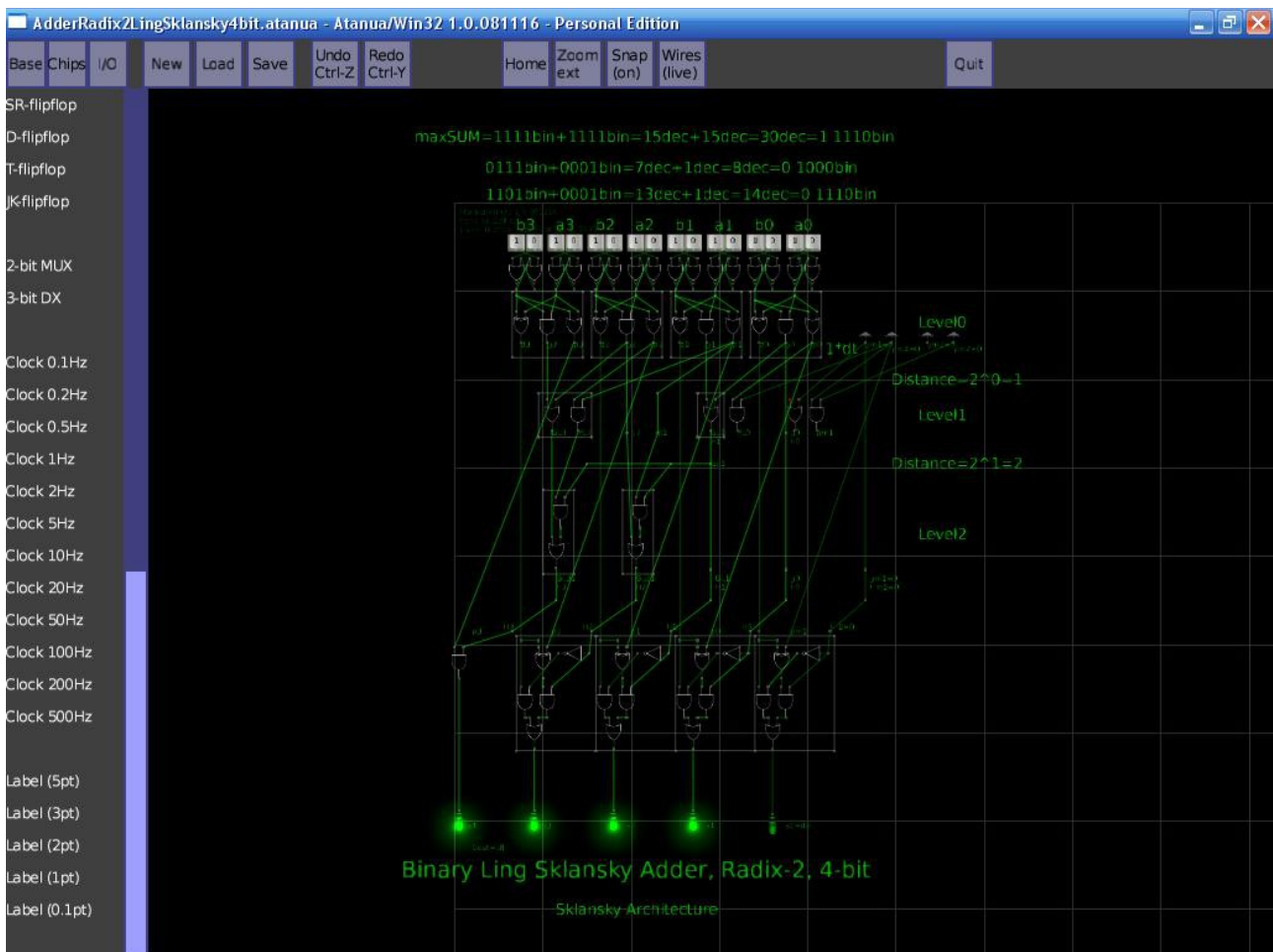
Рис.2. Снимок модели сумматора Линга, архитектура Склянского, Radix-2, 4-х битного (полубайтного) на уровне логических элементов в логическом симуляторе Atanua/Win32 1.0.081116 - Personal Edition .
