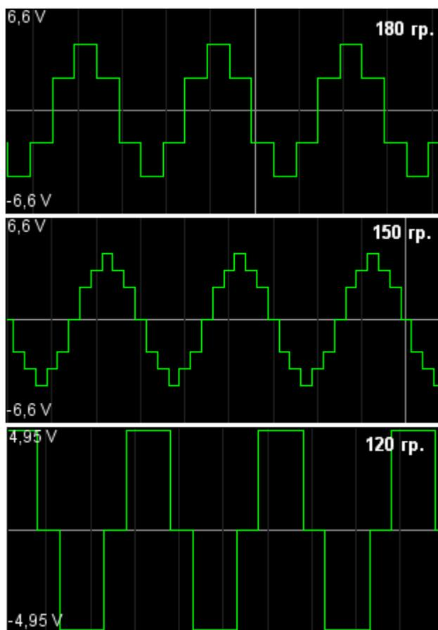
Рис. 4. Снимок графиков фазных напряжений  $U_{a0}$  в трёх моделях 3-х фазных инверторов по схеме Ларионова с углами коммутации  $180^\circ$ ,  $150^\circ$  и  $120^\circ$  в симуляторе электронных схем Circuit Simulator v1.6a.
