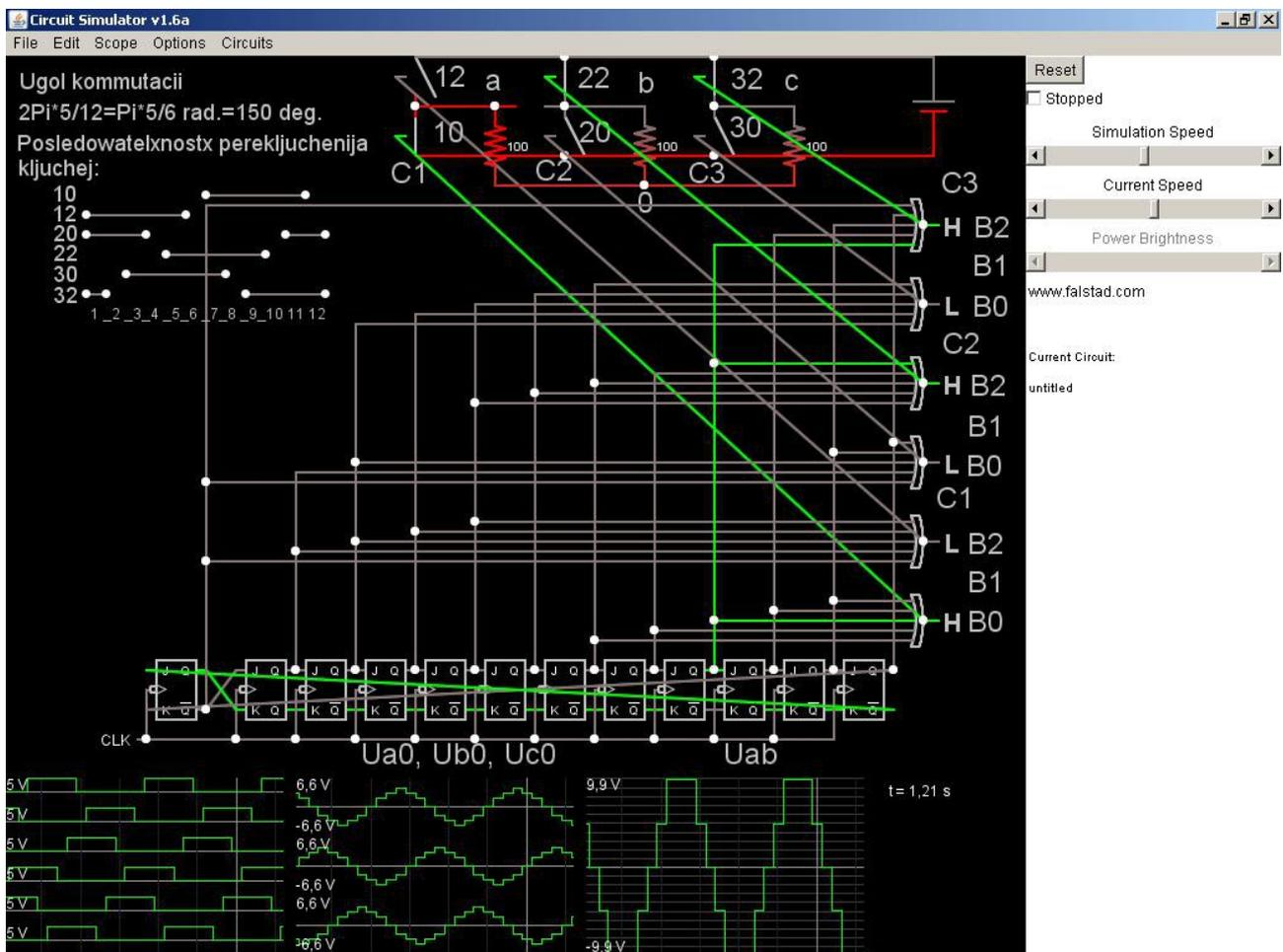
Рис. 3. Снимок с экрана модели №1 3-х фазного инвертора (преобразователя) по схеме Ларионова с включением нагрузки звездой со  $150^\circ$ -ным углом коммутации в симуляторе электронных схем Circuit Simulator v1.6a.
