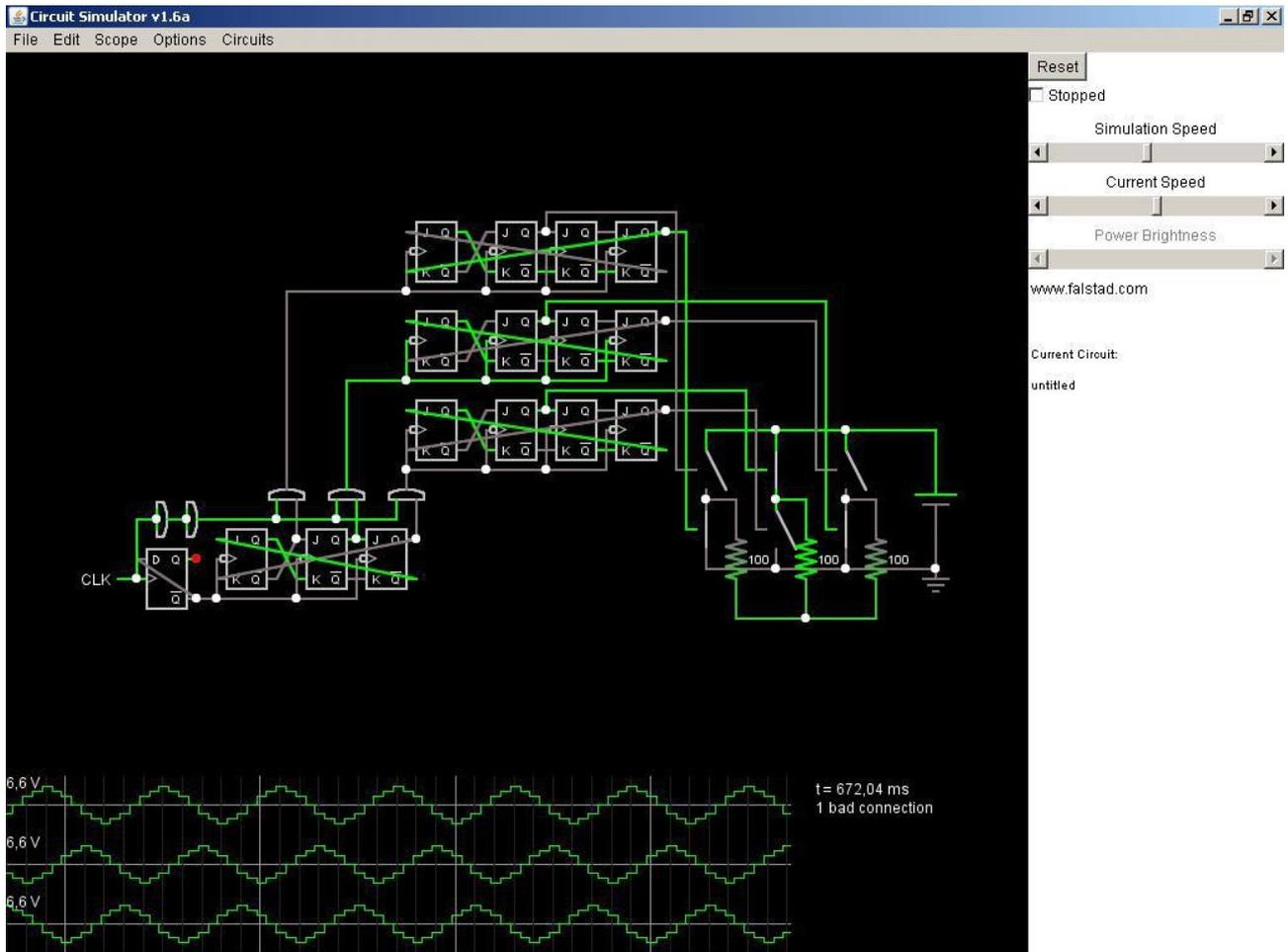
Рис. 5. Снимок с экрана модели №2 3-х фазного инвертора (преобразователя) по схеме Ларионова с включением нагрузки звездой со  $150^\circ$ -ным углом коммутации в симуляторе электронных схем Circuit Simulator v1.6a.
