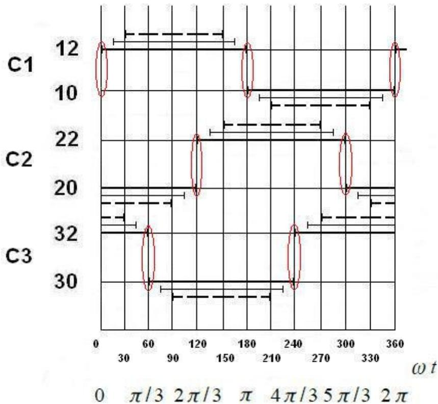
Рис. 2. Графики коммутационных последовательностей со  $180^\circ$ -ным (сплошная толстая),  $150^\circ$ -ным (сплошная тонкая) и  $120^\circ$ -ным (пунктирная толстая) углом коммутации (в овалах переключения при  $180^\circ$ -ном угле коммутации с большой вероятностью возникновения «сквозных токов» короткого замыкания).
