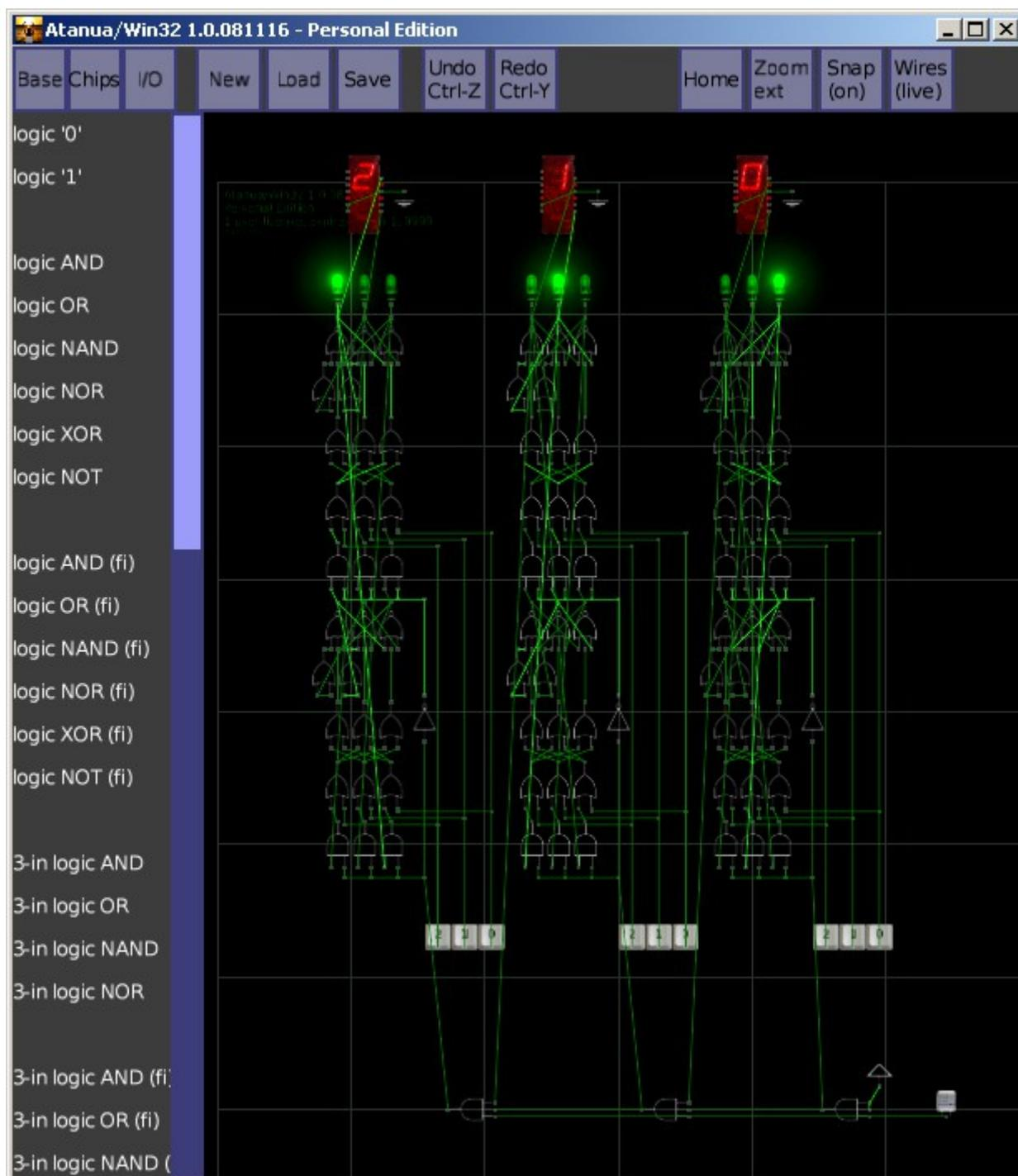
Снимок модели трои́чного трёхбитного (3В ВСТ) счётчика на 27 со сквозным ускоренным переносом с автоматической установкой в 0 при включении и с записью произвольного кода в логическом симуляторе Atanua/Win32 1.0.081116 - Personal Edition.
