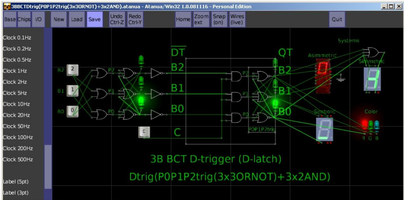
Снимок модели троичного трёхбитного (3В ВСТ) одноступенчатого D-триггера (D-latch) P0P1P2trig(3x3ANDNOT)+3x2ANDNOT в логическом симуляторе Atanua/Win32 1.0.081116 - Personal Edition.
