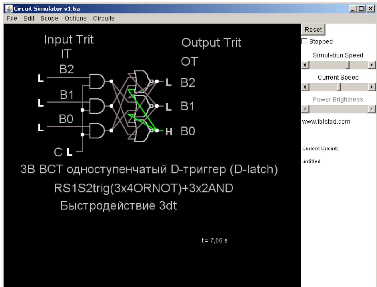
Снимок модели троичного трёхбитного (3В ВСТ) одноступенчатого D-триггера (D-latch) RS1S2trig(3x4ORNOT)+3x2AND в симуляторе электронных схем Circuit Simulator v1.6a.
