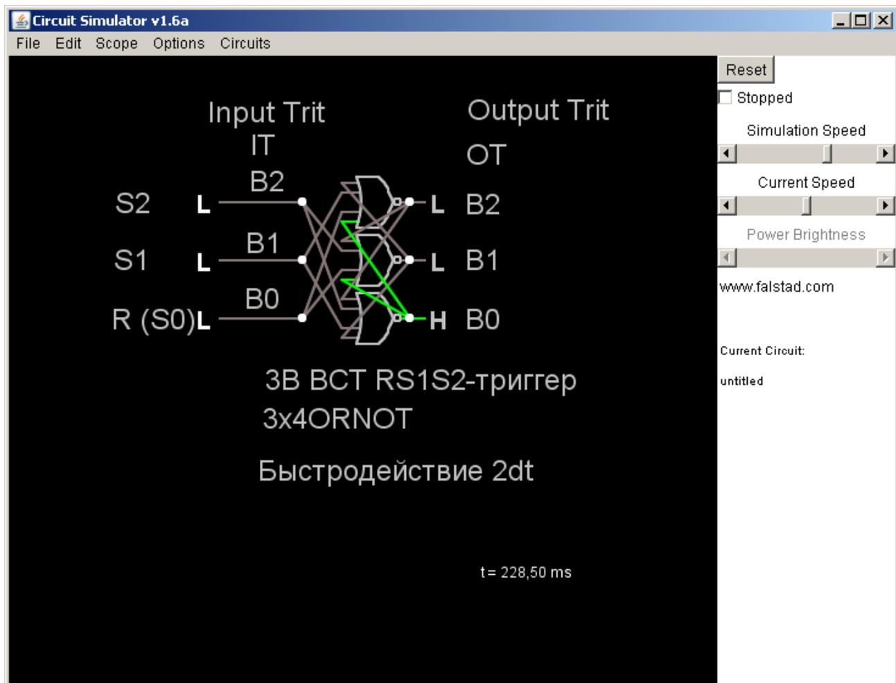
Снимок модели троичного трёхбитного (3В ВСТ) RS1S2-триггера 3x4ORNOT в симуляторе электронных схем Circuit Simulator v1.6a.
