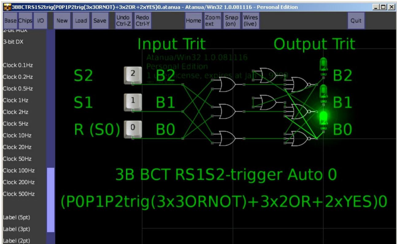
Снимок модели троичного трёхбитного (3В ВСТ) RS1S2-триггера с автоматической установкой в 0 при включении (P0P1P2trig(3x3ORNOT)+3x2OR+2xYES)0 в логическом симуляторе Atanua/Win32 1.0.081116 - Personal Edition.
