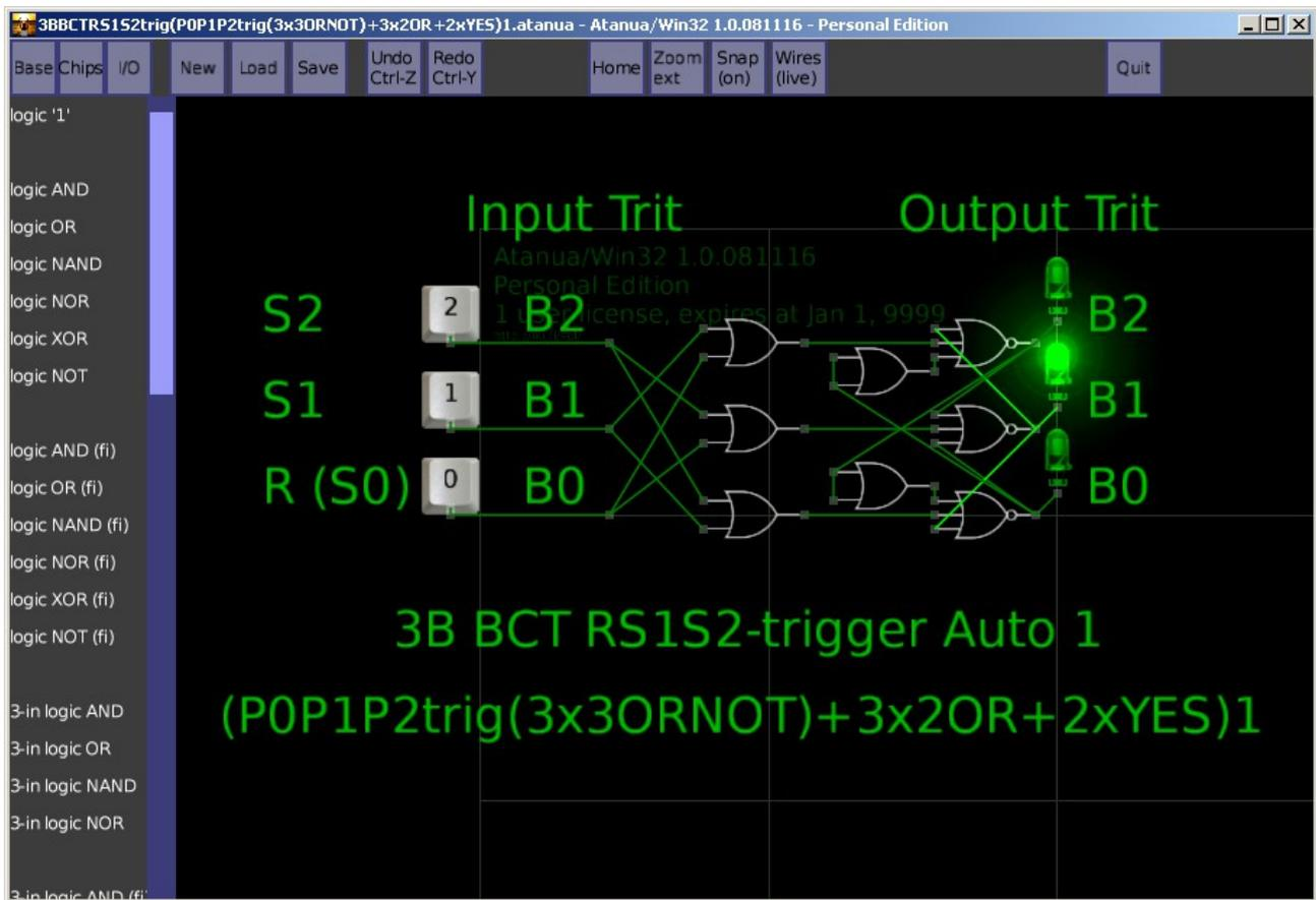
Снимок модели троичного трёхбитного (3В ВСТ) RS1S2-триггера с автоматической установкой в 1 при включении (P0P1P2trig(3x3ORNOT)+3x2OR+2xYES)1 в логическом симуляторе Atanua/Win32 1.0.081116 - Personal Edition.
