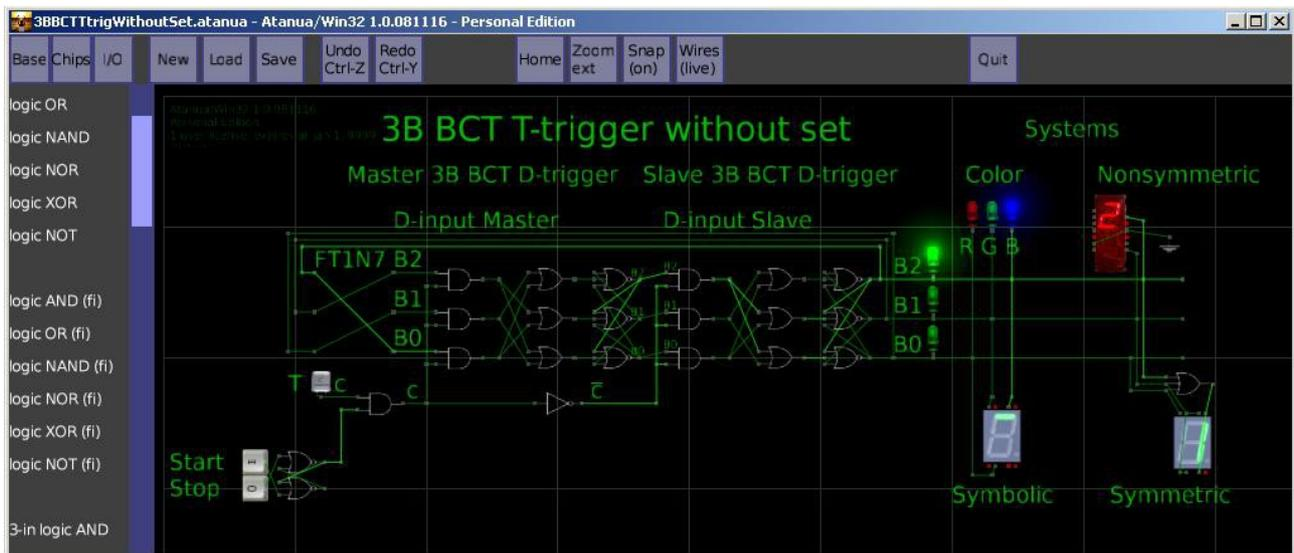
Рис.1. Снимок модели троичного трёхбитного счётного триггера (Т-триггера) без установочных входов в симуляторе логических схем Atanua/Win32 1.0.081116 - Personal Edition.
