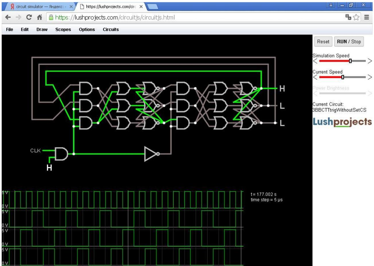
Рис.2. Снимок модели троичного трёхбитного счётного триггера (Т-триггера) без установочных входов в онлайн HTML5-версии симулятора электронных схем Circuit Simulator.
