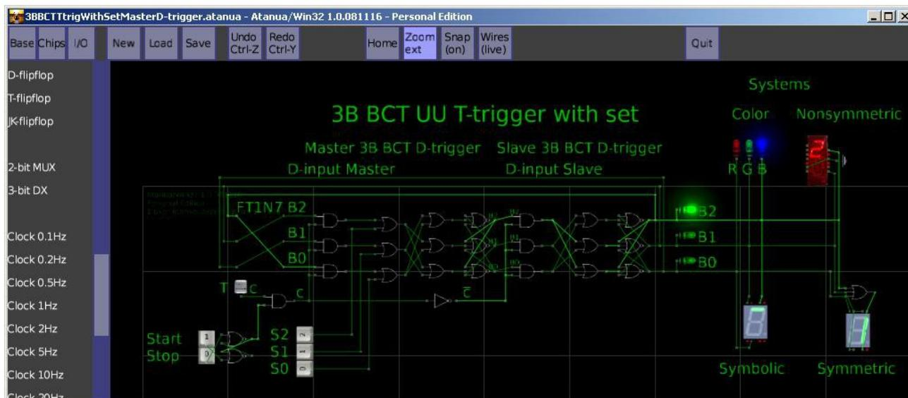
Рис.1. Снимок модели троичного трёхбитного счётного триггера (Т-триггера) с установкой ведущего D-триггера в симуляторе логических схем Atanua/Win32 1.0.081116 - Personal Edition.
