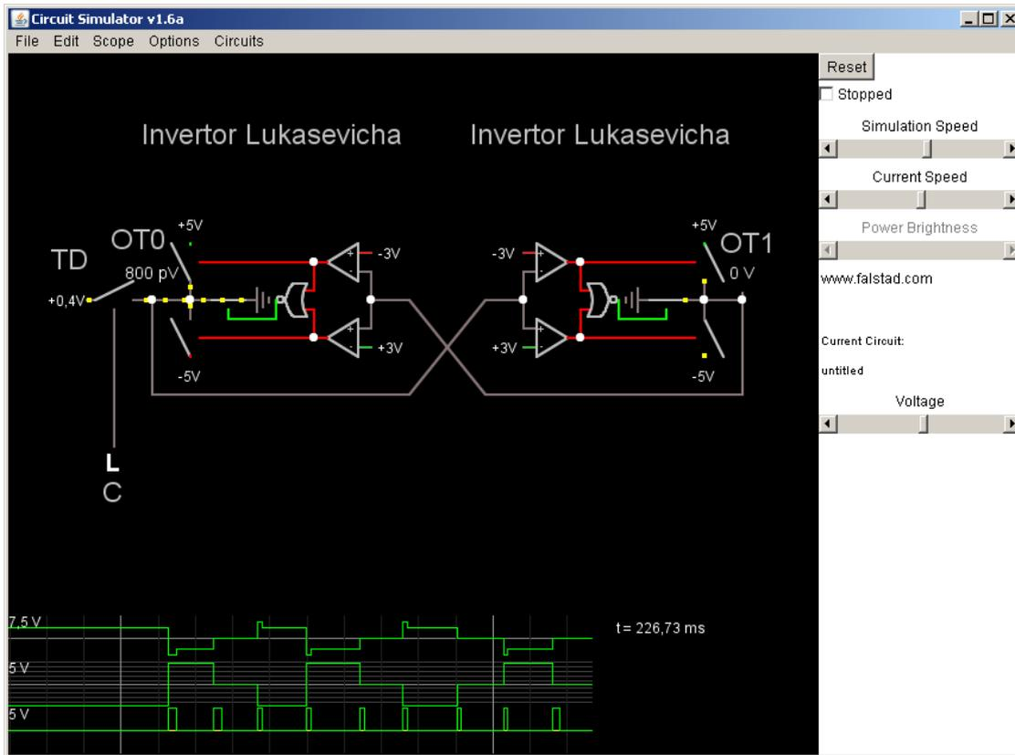
Снимок модели троичного трёхуровневого (3L СТ) одноступенчатого D-триггера на двух инверторах Лукасевича с записью через ключ доступа в электронном симуляторе Circuit Simulator v1.6a.
