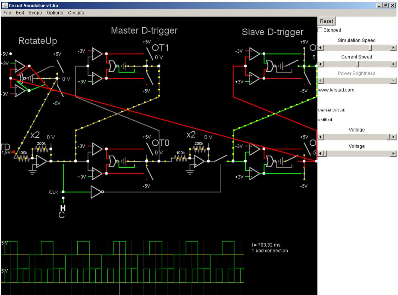
Снимок модели троичного трёхуровневого (3L CT) счётного триггера на троичном двухступенчатом (Master-Slave, MS) D-триггере и троичном логическом элементе RotateUp в цепи обратной связи в электронном симуляторе Circuit Simulator v1.6a.
