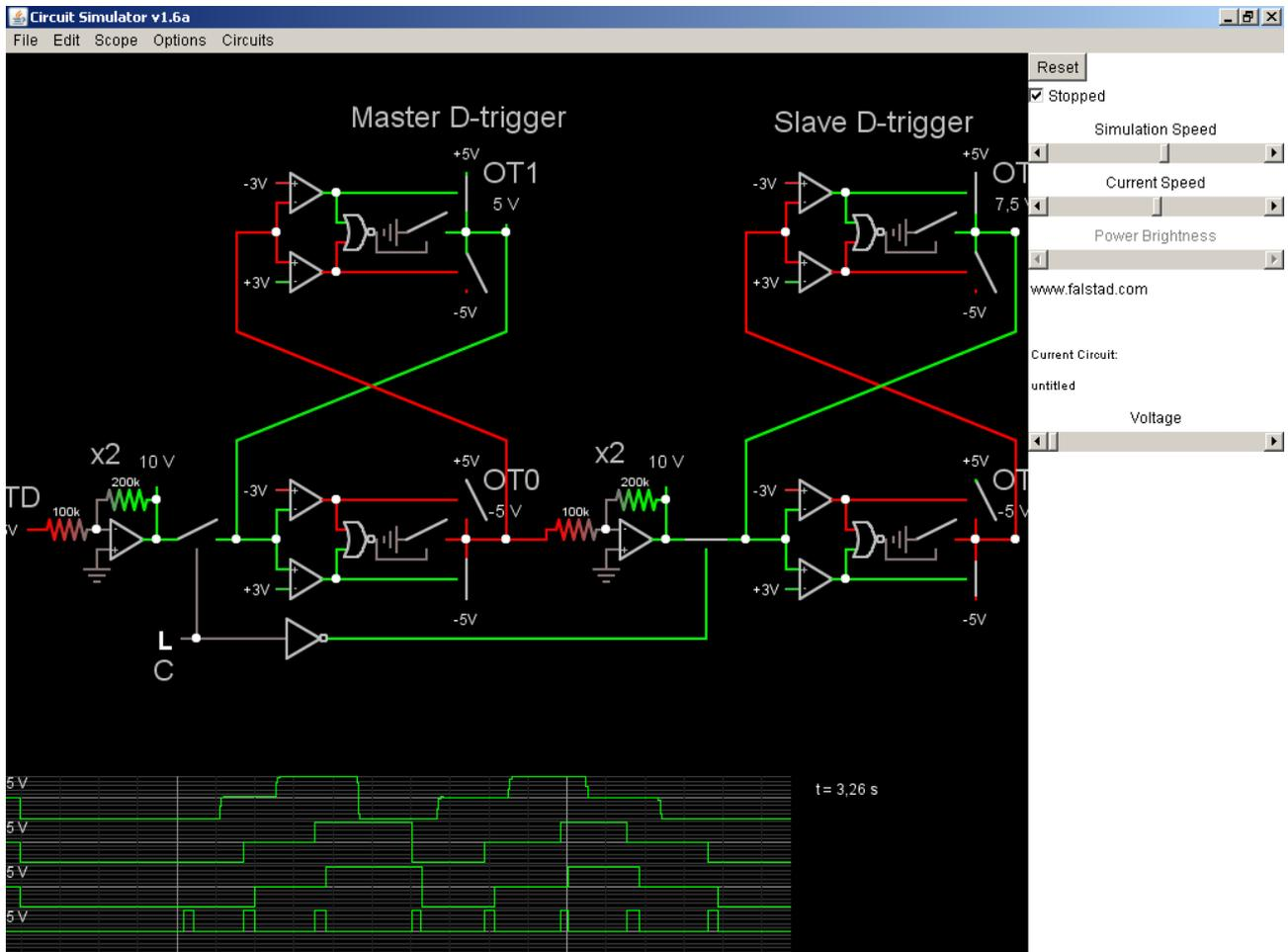
Снимок модели троичного трёхуровневого (3L CT) двухступенчатого (Master-Slave, MS) D-триггера на двух троичных трёхуровневых одноступенчатых D-триггерах в электронном симуляторе Circuit Simulator v1.6a.
