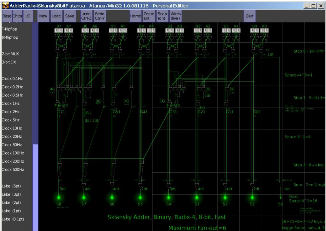
Рис.6. Снимок модели быстрого двоичного сумматора Склянского, Radix-4, 8-ми битного, в логическом симуляторе Atanua/Win32 1.0.081116 - Personal Edition .
