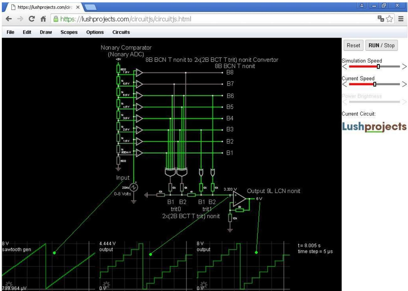
Рис.2. Снимок модели девятиричного АЦП прямого преобразования, однополярного, однононитного, с одноступенчатым преобразователем в 2 трита в онлайн версии симулятора электронных схем Circuit Simulator.
