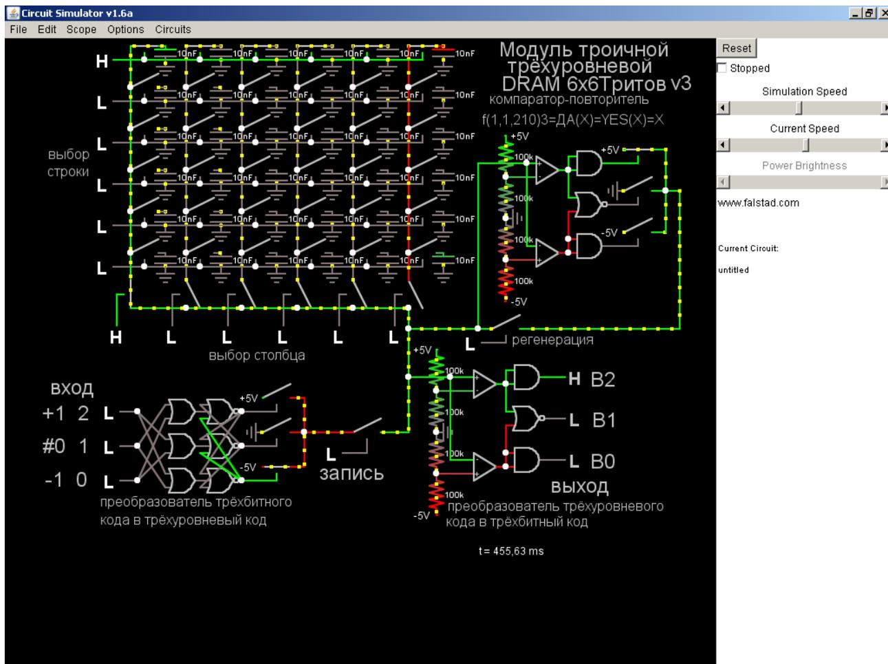
Снимок модели модуля троичной трёхуровневой (3LCT) DRAM 6x6=36 Тритов с произвольным доступом к любому триту с устройствами сопряжения с трёхбитной (3В ВСТ) системой в симуляторе электронных схем Circuit Simulator v1.6a.
