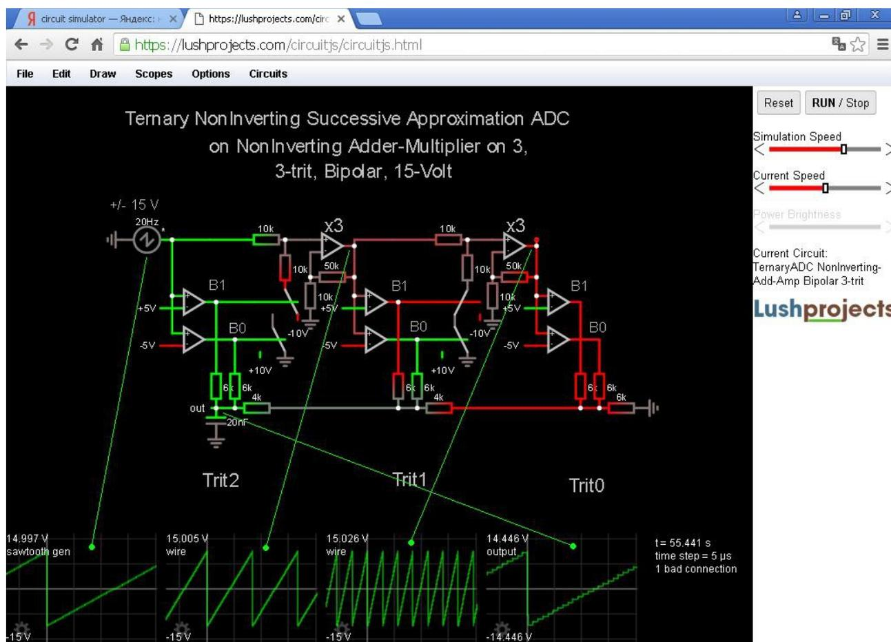
Рис.1. Снимок модели троичного неинвертирующего АЦП последовательного приближения на неинвертирующем сумматоре-умножителе на 3, 3-х тритного, биполярного, 15-ти вольтного, в онлайн HTML5-версии симулятора электронных схем Circuit Simulator.
